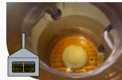
Nur der Trubkegel aus Hopfenresten bleibt im Kessel zurück
